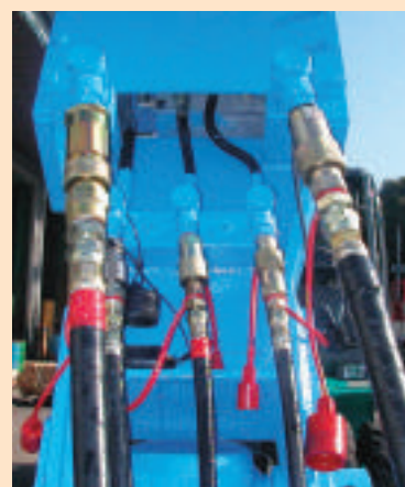
スイベルジョイントとワンタッチカプラー 油圧ホースのねじれを防ぎ、脱着はワンタッチ。
